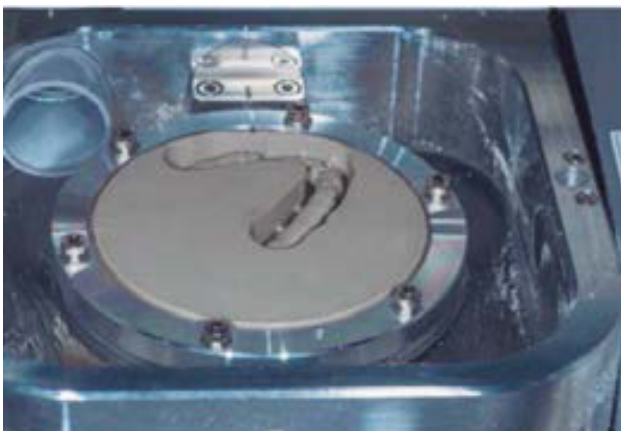
Figura 18. Disco en la fresadora.
